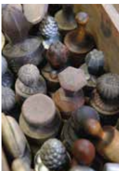
鉄瓶や茶釜などの蓋のつまみをつくるための型。シンプルな丸形や松ぼっくりなどデザインは多彩。これに粘土をかぶせ、型をとって鉄を流し込みます。
